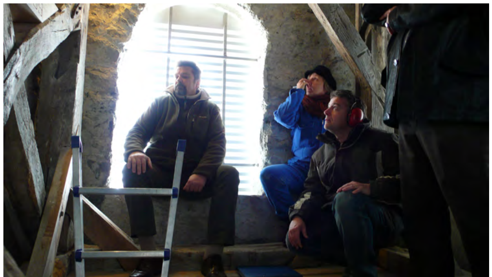
fig. 80 et 81: Essais de mise en volée des trois cloches simultanément et observation des oscillations de la charpente du beffroi. Définition des derniers calages des assemblages du beffroi et réglages des courses des mises en volée.
