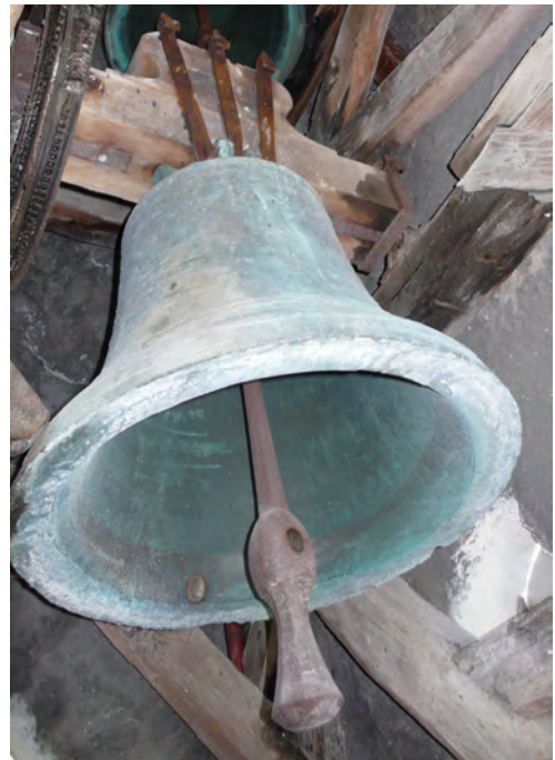
fig. 14: Vue d'un des trois battants inadaptés, trop longs et trop lourds et usé au point de frappe.
